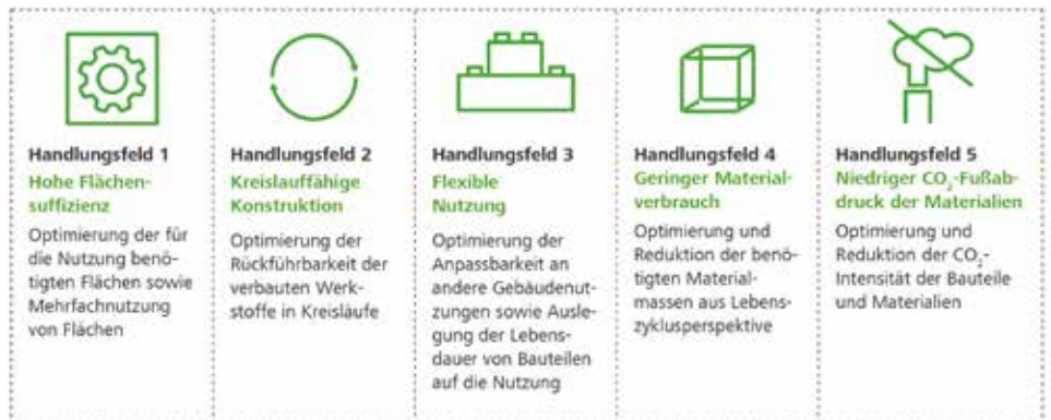
Abb.2: Handlungsfelder für eine klimaschonende Konstruktion
