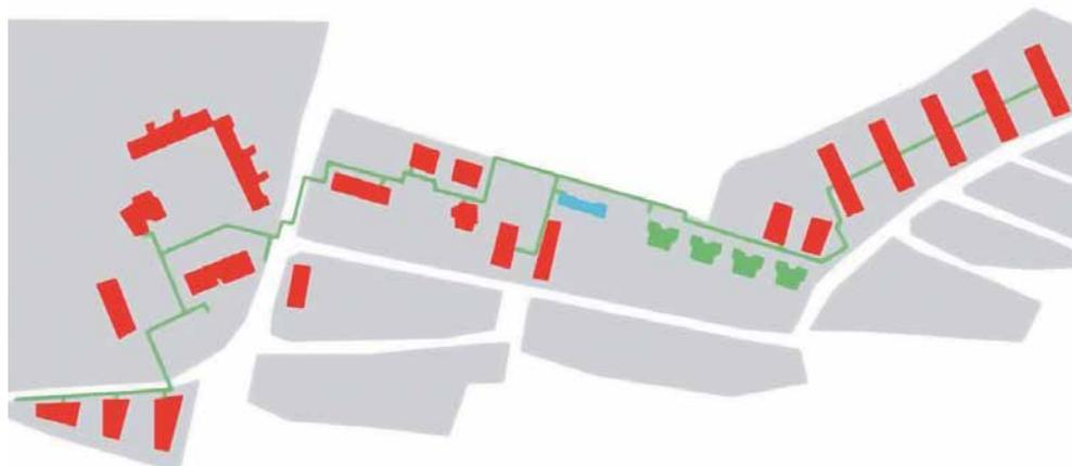
Abb. 2: Schematische Darstellung des Wärmenetzes Am Pfeiferhölzle: Von der Heizzentrale (links unten) aus werden 650 Einheiten versorgt – WOBAK-Gebäude und die von Dritten gleichermaßen.
